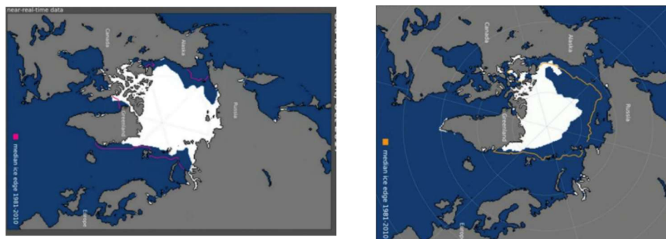
Hiver à gauche, été à droite – les brise-glace nucléaires de 33000 t permettent la route 9 mois sur 12. L'ouverture permanente nécessiterait un brise-glace de 60 000 t.
